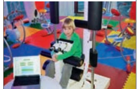
das Messgerät EasyTorque Kids entwickelt. Mit ihm kann der aktuelle Leistungsstand bei Kindern in Form der sportmotorischen Eigenschaft Kraft bestimmt werden. Das Gerät greift auf die bewährte Technik des EasyTorque zurück.
